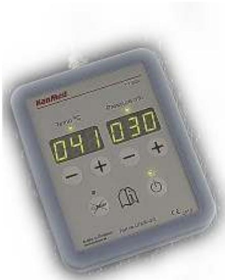
**La temperatura e la pressione** del materasso sono indicate sull'unità di controllo manuale. Le impostazioni si modificano facilmente con i tasti +/-
