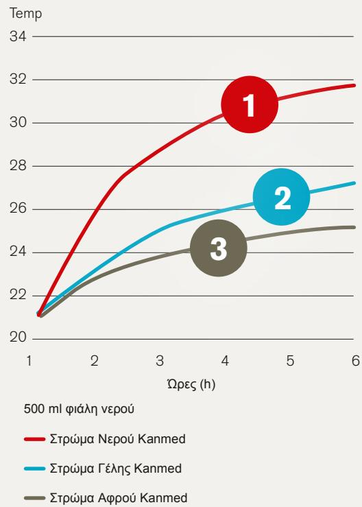
Για να εκπιμηθεί η αποτελεσματικότητα θέρμανσης τοποθετήθηκε μια πλαστική φιάλη με 500 ml νερό σε κάθε τύπο στρώματος όταν ήταν σε σταθερή κατάσταση σε 37°C. Η φιάλη καλύφθηκε με ένα διπλό στρώμα βαμβακερής πετσέτας. Στη συνέχεια καταγράφηκε η αύξηση της θερμοκρασίας στο νερό. Όπως φαίνεται ανωτέρω στο Στρώμα Νερού έχει την υψηλότερη μεταφορά ενέργειας και γι' αυτό είναι το αποτελεσματικότερο σύστημα θέρμανσης.
