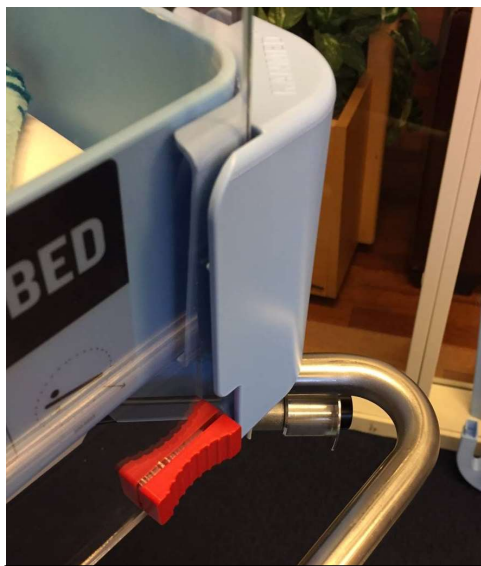
Kallutuse vabastamise napp külgsiinideta mudelitel
