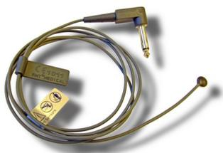
A função de monitorização de temperatura será ativada automaticamente assim que for instalado um sensor de temperatura (pele) compatível com YSI400 na entrada dianteira (T) do tipo de microfone de 6,3 mm. A temperatura do sensor será visualizada no canto superior esquerdo do ecrã.
