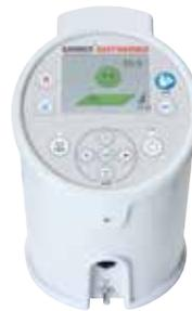
L'unité de contrôle est facile d'utilisation. Un affichage indique clairement lorsque la température du matelas est correcte. Toute manipulation ou erreur technique va créer une alarme.
